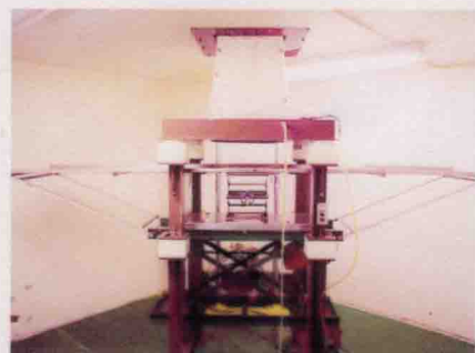
垂直方向試験体支持台(地下室)
